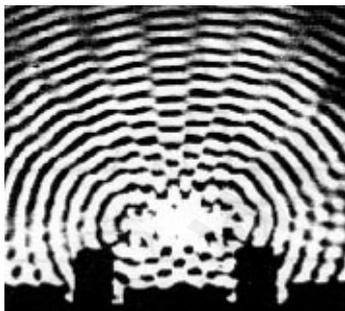
Fig. XVII-21.- Fotografía de un «espectro de interferencias» de ondas de agua producidas en una cubeta de ondas.
