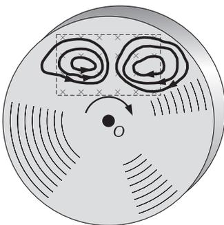
Fig. XXII-9.- Corrientes de Foucault producidas en un disco en rotación al penetrar una parte de él en un campo magnético homogéneo.
