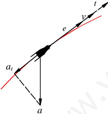
21. Las ecuaciones paramétricas de las coordenadas de la punta de un brazo mecánico son  $x = 25t - 4t^2$  y  $y = 50 - 2t^2$ ; ambas resultan en ft, si el tiempo está en s. Diga qué longitud tiene el radio de curvatura de la trayectoria de la punta cuando  $y = 0$ .
