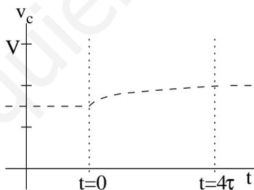
Figura 4: Evolución de la carga del condensador.
