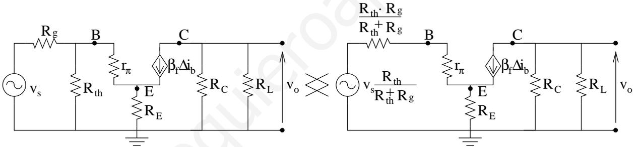
Figura 13: Circuito con  $R_g$  no perteneciente al generador de entrada
