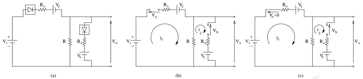
Figura 7: (a) Circuito para tensión  $V_i$  positiva, (b) Modelo de los diodos ideales para  $V_i = 0$  y (c) Diodo 1 en conducción y diodo 2 en corte
