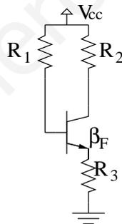
Figura 10: Circuito de polarización
