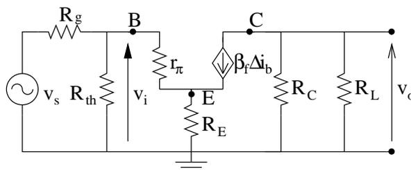
Figura 12: Circuito con  $R_g$  perteneciente al generador de entrada
