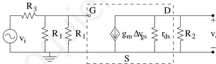
Figura 15: Circuito equivalente de pequeña señal
