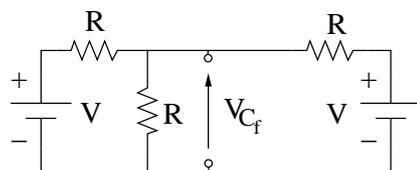
Figura 2: Circuito final si consideramos el condensador como un circuito abierto
