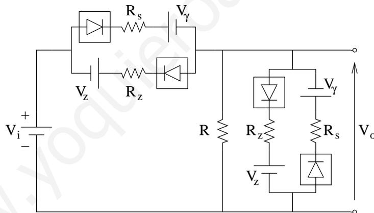
Figura 6: Circuito con los equivalentes por tramos lineales para cada diodo
