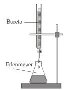
El procedimiento experimental consiste en colocar en el matraz erlenmeyer un volumen conocido de la disolución que queremos valorar, y desde la bureta, dejamos caer gota a gota la disolución patrón, hasta que llegamos a un punto, denominado punto de equivalencia, en donde no queda en la muestra ni ácido ni base libre.
