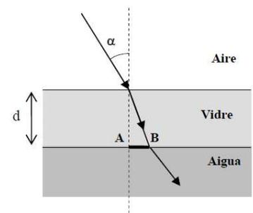
b) Deduce la expresión de la distancia (AB) de desviación del rayo tras atravesar el vidrio y calcula su valor numérico. La placa de vidrio tiene un espesor de 30 mm y su índice de refracción es de 1,6. **Sol: 9,87mm.**
