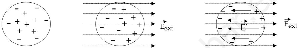
Sin embargo, al introducir un dieléctrico, las cargas no pueden separarse completamente. En una sustancia polar, los dipolos se deforman y orientan en el sentido del campo eléctrico, y en una apolar se forman dipolos instantáneos (inducidos). En ambos casos se crea un campo inducido que se opone al campo exterior, pero no llega a ser suficientemente intenso como para anularlo. El campo interior se hace más pequeño que el exterior, pero no se hace cero.
