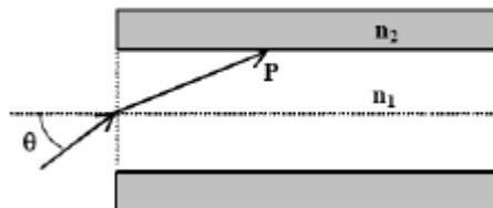
Siendo el índice de refracción,  $n_1$ , dentro de la fibra 1,48 y el del revestimiento de la fibra,  $n_2$ , un índice de refracción de 1,44
