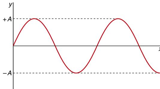
Esta gráfica nos muestra la posición de cada punto de la onda en ese instante dado. Como vemos, los puntos separados una distancia igual a la longitud de onda están en el mismo estado de vibración (igual valor de la elongación, velocidad y aceleración).
