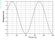
$$\begin{array}{ccc} & \text{Amplitud} & \text{A} = 8\,\text{m} \\ \text{A la vista de la gráfica: Periodo} & \text{T} = 60\,\text{s} \\ & \text{Elongación inicial} & \text{y}_0 = 4\,\text{m} \\ \end{array} \right\} \rightarrow \omega = \frac{\pi}{30} \text{s}^{-1}$$
