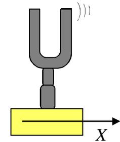
Longitud de onda: cálculo a partir de  $v = \frac{\lambda}{T} = \lambda \cdot f \rightarrow \lambda = \frac{v}{f} = \frac{344}{275.2} = \frac{5}{4} = 1.25 \text{ m}$
