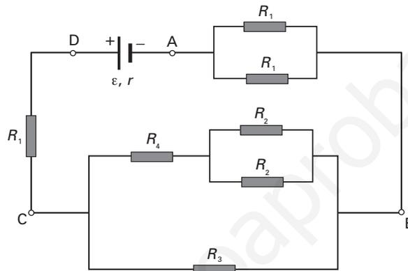
a) Hay un acoplamiento en paralelo de dos resistencias  $R_2$ , que equivalen a una resistencia  $R'$  tal que:
