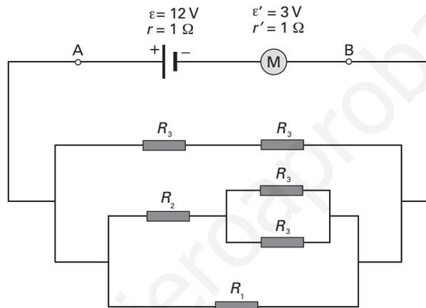
a) Hay que calcular la resistencia equivalente en el circuito.
