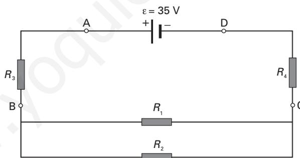
a) Las resistencias  $R_1$  y  $R_2$  están en paralelo, por tanto, se pueden sustituir por una  $R'$ , colocada entre los mismos puntos cuyo valor es tal que:
