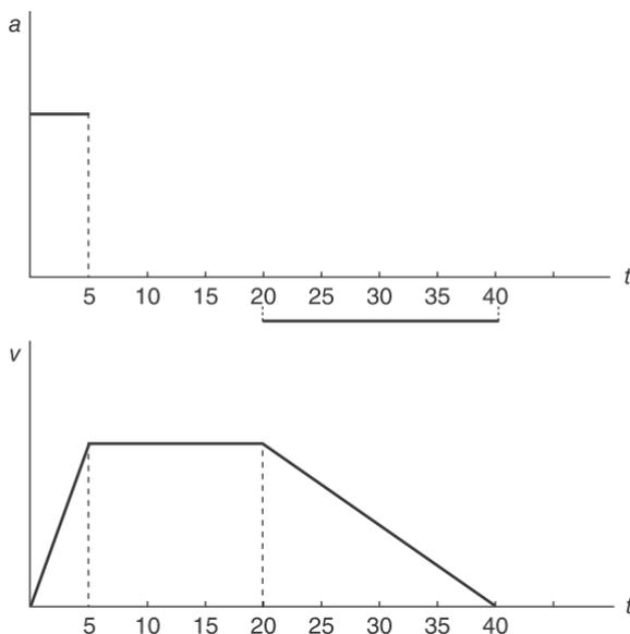
23> En la Figura 6.41 está representado el diagrama  $v-t$  del movimiento de un objeto lanzado verticalmente hacia arriba desde el suelo.
