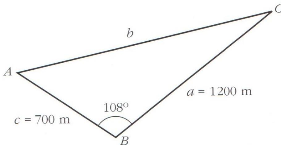
Aplicamos el teorema del coseno para calcular el lado
