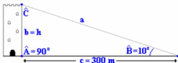
Aplicando la definición de de tangente al ángulo B se puede calcular la altura de la torre.
