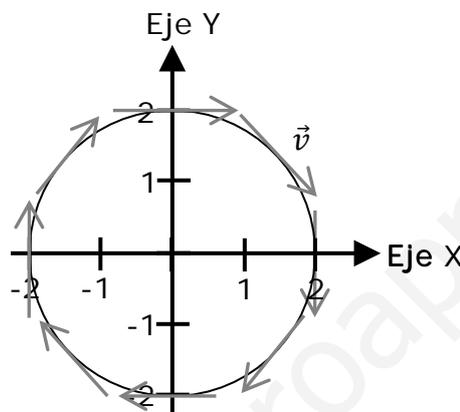
Como la velocidad cambia continuamente a lo largo de la trayectoria de un MCU esto significa que existe una aceleración. En un MCU el módulo de la velocidad no varía, por lo tanto solo existe **aceleración centrípeta**:
