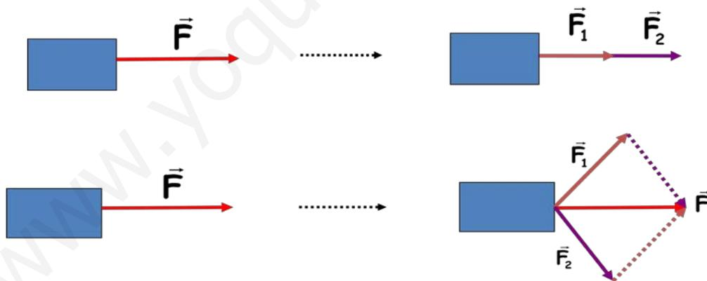
Existen infinitas formas de descomponer un vector en dos diferentes y todas son válidas. Sin embargo, nosotros nos vamos a centrar en una que resulta especialmente útil llamada **composición normal o rectangular**. En esta composición los vectores obtenidos (componentes) son perpendiculares entre sí:
