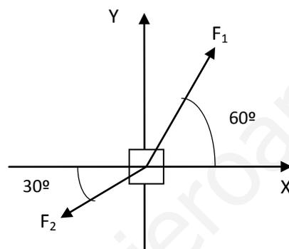
11. Sobre un cuerpo se aplican las siguientes fuerzas:  $F_1 = 3\text{ N}$  dirigida en el eje OX positivo,  $F_2 = 3\text{ N}$  dirigida según el eje OY negativo. Calcula la tercera fuerza necesaria para que el sistema este en equilibrio.
