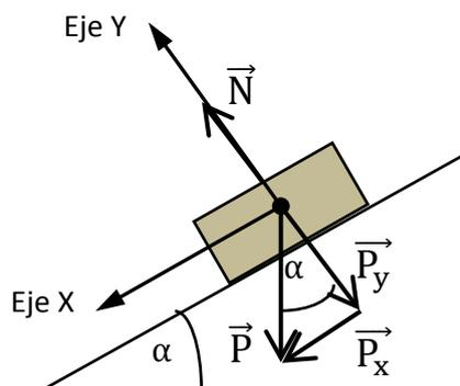
Según se muestra en la figura en este caso la normal tiene sentido opuesto e igual módulo y dirección que la componente  $\vec{P}_y$  del peso. Aplicando la segunda ley de Newton para las fuerzas del eje Y obtenemos:
