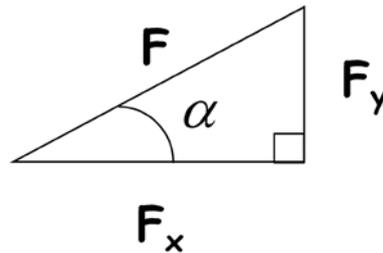
Aplicando las definiciones de seno y coseno obtenemos las dos componentes normales ( $F_x$ ,  $F_y$ ) de  $F$ :
