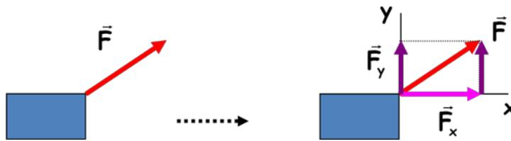
Vemos como en este caso hemos descompuesto  $F$  en dos vectores perpendiculares ( $F_x$ ,  $F_y$ ). Si observamos la figura anterior vemos que  $F$ ,  $F_x$ ,  $F_y$  forman un triángulo rectángulo:
