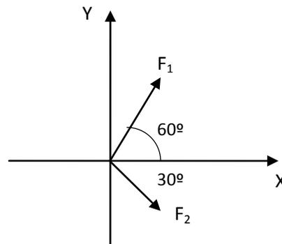
10. Calcula el valor del módulo de la fuerza resultante  $F_R$  sobre un cuerpo al que se aplican dos fuerzas constantes de módulos  $F_1 = 8\text{ N}$  y  $F_2 = 4\text{ N}$ , en la direcciones y sentidos que se indican en el dibujo. Haz otro dibujo donde aparezca también la dirección y sentido de dicha fuerza resultante
