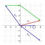
2.-  $(1_{pto})$  Calcula gráfica y analíticamente la resultante del sistema de fuerzas concurrentes:  $F_1$  (5N; 126,87°),  $F_2$  (3N; 0°) y  $F_3$  (5N; 323,13°).
