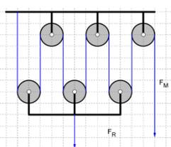
10.- (1<sub>pto</sub>) En el sistema de poleas de la figura ¿qué fuerza debo ejercer para elevar una masa de 1000 kg? ¿Cuánta cuerda debo recoger para subir la masa 6 m?
