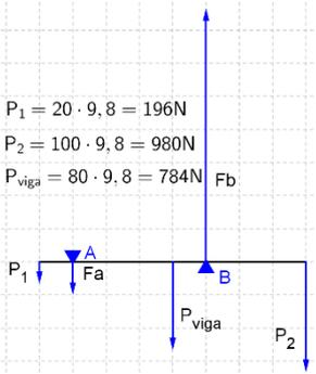
7.- (1<sub>pto</sub>) Una viga homogénea, de 8 m de largo y 80 kg de masa se encuentra horizontal apoyada en un punto A situado 1 m del extremo izquierdo y en un punto B situado a 4 m de A. Del extremo izquierdo cuelga un cuerpo de 20 kg y del extremo derecho cuelga otro de 100 kg. Calcular la fuerza que soportan los apoyos A y B. Interpretar el resultado. Haz un dibujo representativo del problema.
