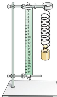
La diferencia entre la longitud del muelle con pesas y sin pesas se denomina alargamiento. Se repite la operación utilizando diferentes masas y se miden los respectivos alargamientos. En la tabla se recogen los datos obtenidos.
