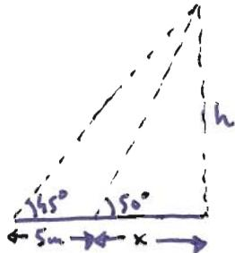
$$\begin{array}{l} \text{triángulo pequeño: } \tan 50^\circ = \frac{h}{x} \\ \text{triángulo grande: } \tan 45^\circ = \frac{h}{x+5} \end{array} \left\{ \begin{array}{l} h = x \cdot \tan 50^\circ \quad (1) \\ h = (x+5) \cdot \tan 45^\circ \quad (2) \end{array} \right.$$
