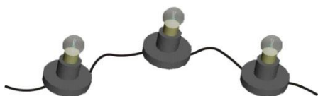
Fig.3: Bombillas montadas en serie
