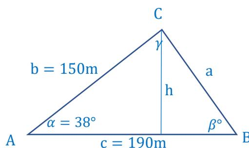
Recuerda que conocidos dos lados y el ángulo entre ellos para resolver el triángulo se debe en primer lugar calcular lado restante por el Teorema de los cosenos. Después calcular un ángulo utilizando un lado menor utilizando el Teorema de los senos. El último ángulo se calcula por la suma de los ángulos  $180^\circ$ .
