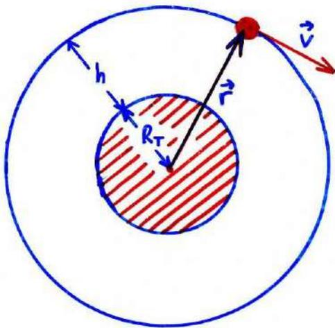
Recordando que la Tierra se comporta como una partícula de masa total:  $m_T$ , situada en el centro del planeta (teorema de Gauss), e igualando la fuerza gravitatoria a la fuerza centrípeta, necesaria para el movimiento circular uniforme del satélite, calculamos su velocidad lineal:
