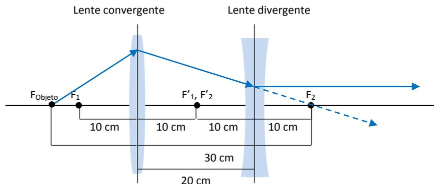
Este rayo, según se observa en el dibujo, de no existir la lente divergente, habría cortado al eje óptico en el punto donde está  $F_2$ , es decir, a una distancia de 30 cm de la lente convergente. Calculemos entonces usando la ecuación de las lentes delgadas de dónde viene dicho rayo.
