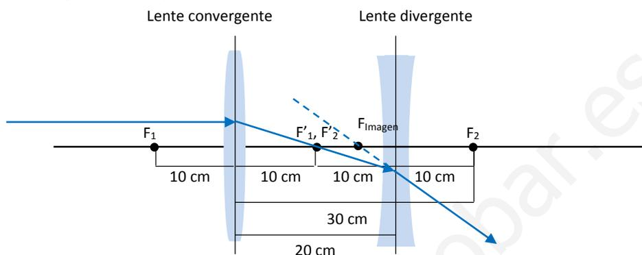
El rayo que incide paralelo en la lente divergente pasará por el foco imagen de la lente convergente y a continuación llegará hasta la lente divergente. De ahí saldrá siguiendo una dirección cuya prolongación cortará al eje óptico en el foco imagen, tal y como se muestra en el esquema.
