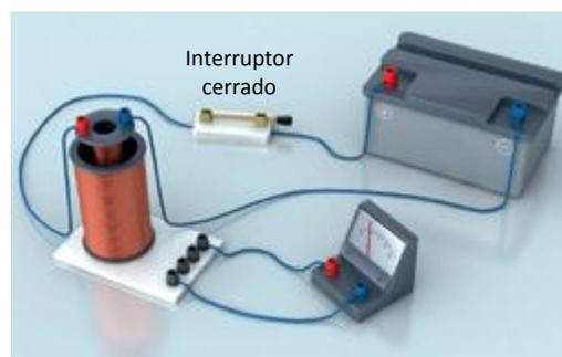
Durante esos instantes se produce una variación en el valor del campo magnético que crea la bobina por la que pasa la corriente que proporciona la batería. Entonces se produce también una variación en el flujo magnético que pasa por la bobina exterior.
