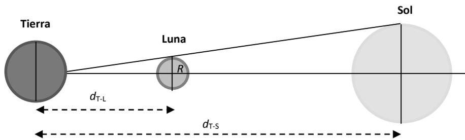
$$\frac{d_{T-L}}{D_L} = \frac{d_{T-S}}{D_S} \rightarrow \frac{D_S}{D_L} = \frac{d_{T-S}}{d_{T-L}}$$
