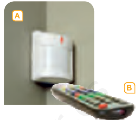
4 A. Sensor de movimiento que se instala en las alarmas. B. Sensor de infrarrojos que se utiliza para controlar la televisión a distancia.
