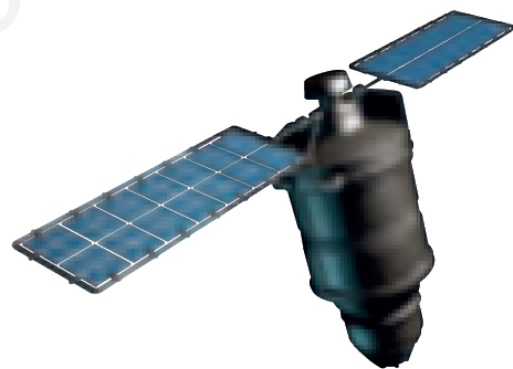
② Satélite artificial. Las superficies que sobresalen son paneles solares que proporcionan energía eléctrica al satélite.
