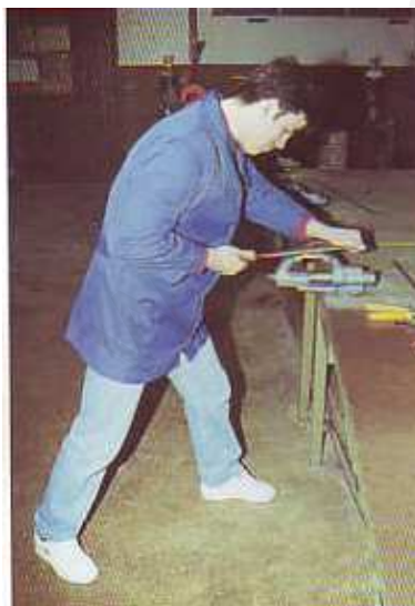
Fig. 3. Posición correcta de limado.
