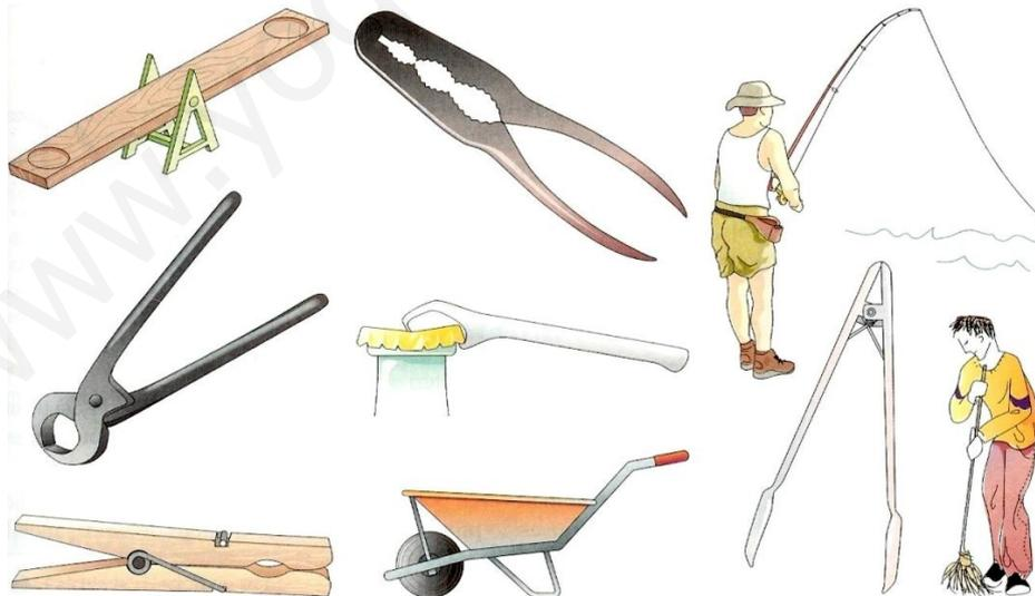
El efecto de la fuerza aplicada puede verse aumentado o disminuido. El efecto de la fuerza aplicada siempre se ve aumentado ( $d > r$ ). El efecto de la fuerza aplicada siempre se ve disminuido ( $d < r$ ).
