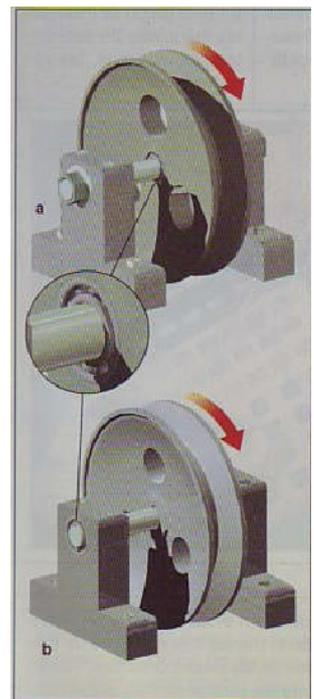
Fig. 2. Tipos de ejes: a) fijo; b) giratorio.
