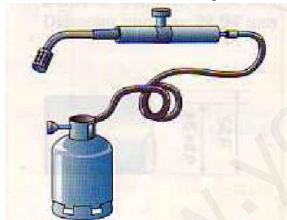
Figura 11.29. Soldador alimentado por butano o propano.
