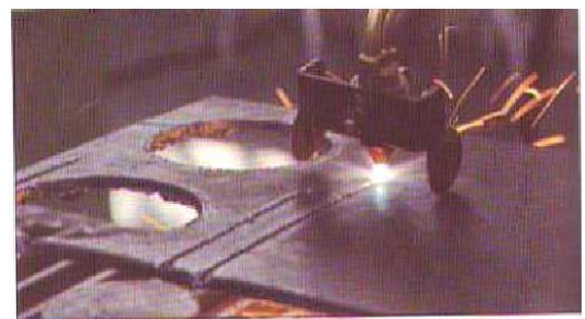
Fig. 11. Proceso de oxicorte.
