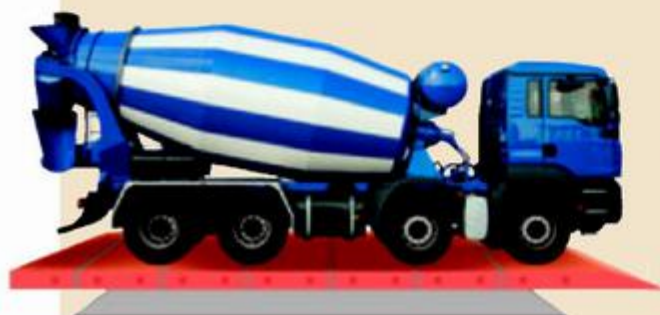
Balanza de camión. Precisión: 1 kg. Cota máxima: 50 toneladas.
