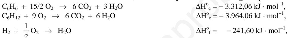
Multiplicando la reacción de formación del agua por 3, incluida su entalpía, invirtiendo el sentido de la reacción de combustión del ciclohexano y cambiando el signo a su entalpía, y sumando las 3 (ley de Hess), se obtiene la reacción de hidrogenación del hexeno y su entalpía:
