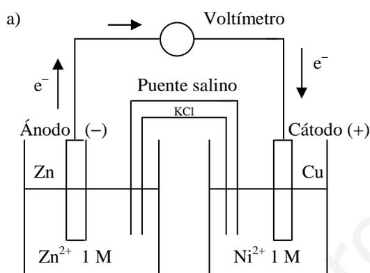
b) En el ánodo tiene lugar la siguiente semirreacción de oxidación:  $\text{Zn} + 2 e^- \rightarrow \text{Zn}^{2+}$ .
