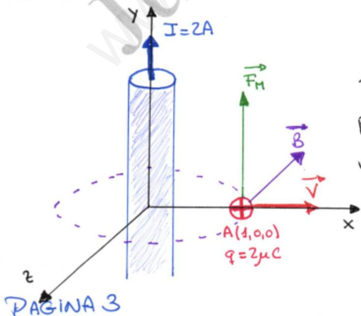
El conductor rectilíneo crea un campo magnético en el punto A(1,0,0) cuyo módulo viene dado por:
