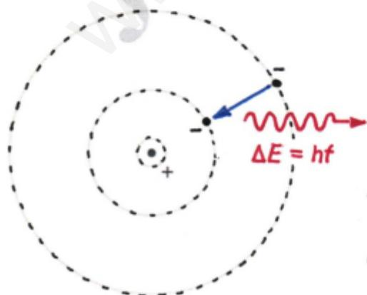
En una transición electrónica en la que se libera energía, un electrón "salta" de un nivel electrónico de energía  $E_2$  a otro de energía menor  $E_1$ .
