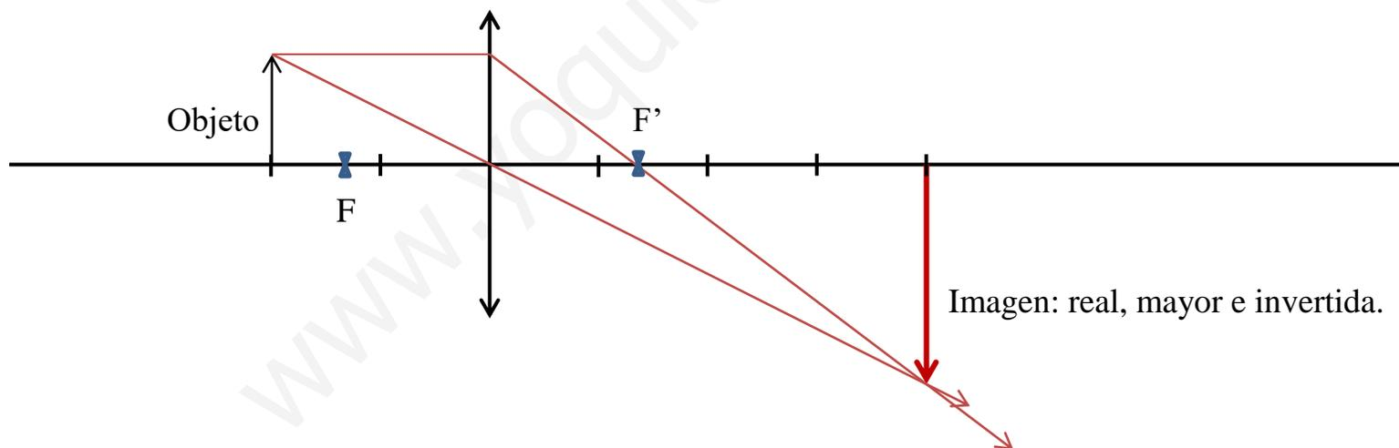
c) Si colocamos la pantalla a 8 m de la lente, ¿dónde colocaremos el objeto para que la imagen se siga produciendo en la pantalla? Realiza la construcción geométrica (trazado de rayos) manteniendo las proporciones.
