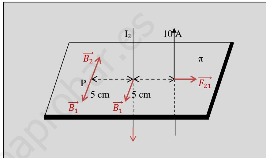
Supongamos dos cables o hilos conductores rectilíneos y paralelos por los que circulan dos corrientes de intensidades  $I_1$  e  $I_2$ , respectivamente. Cada corriente crea en el espacio que la rodea un campo magnético que ejerce una fuerza magnética sobre la otra corriente eléctrica. Esta interacción magnética mutua será atractiva si las corrientes poseen el mismo sentido, y repulsiva si las corrientes poseen sentidos contrarios.
