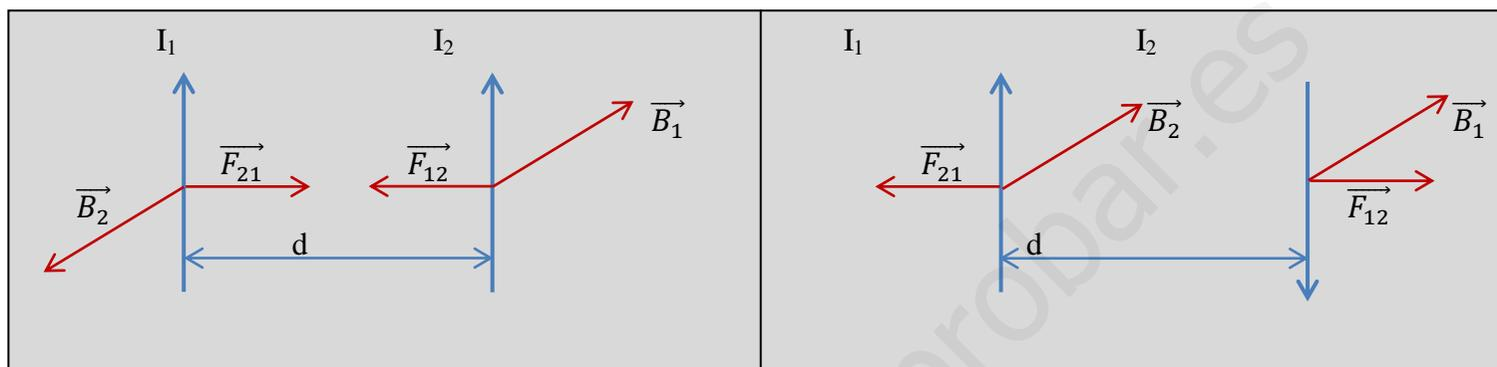
Si consideramos dos trozos o segmentos de los conductores de igual longitud  $L$  y llamamos  $r$  a la distancia que los separa, las fuerzas magnéticas se calculan de la siguiente manera:
