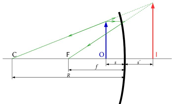
Como los rayos no se cortan, se prolongan al otro lado del espejo hasta que sus prolongaciones se cortan. El punto de corte es el correspondiente a la imagen I.
