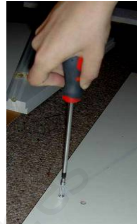
Tanto el tornillo como la punta del destornillador están sufriendo torsión
