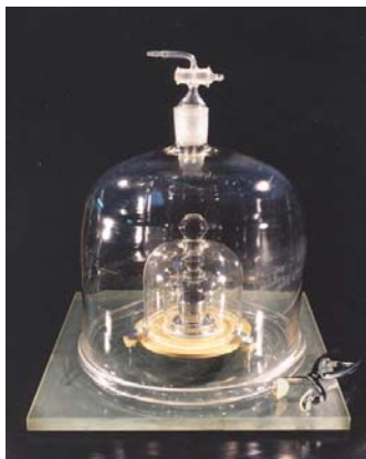
El prototipo internacional del kilogramo, K, el único patrón materializado que permanece para definir una unidad básica del SI.
