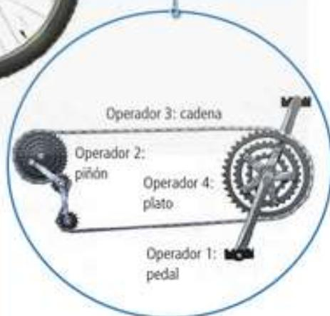
Las **máquinas compuestas** resultan de la unión de diferentes piezas. Estas se agrupan formando las distintas **partes** de la máquina. Cada una de esas partes se llama **operador**.
