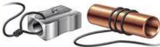
**1** Coge dos trozos de cable eléctrico. Enrolla uno al tubo de cobre y ata el otro al sacapuntas.
