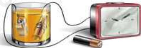
**4** Si no funciona, prueba a intercambiar los cables y observarás que empieza a funcionar.
