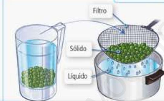
La **filtración** permite separar los componentes de una mezcla formada por un líquido y un sólido. Para ello, se hace pasar la mezcla a través de un **filtro**. El sólido queda en el filtro y el líquido pasa al recipiente.
