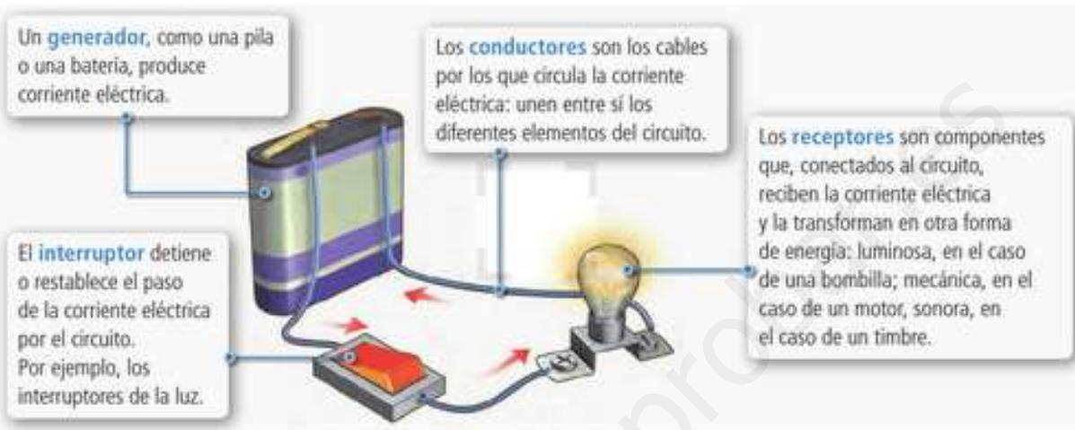
Los circuitos eléctricos se representan mediante **esquemas** en los que cada componente tiene un símbolo, como se observa a continuación.
