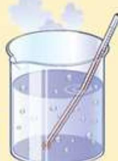
El galio se contrae (se deposita en la parte inferior del termómetro) cuando la temperatura descende y se dilata (asciende) si aumenta la temperatura.
