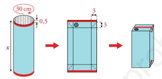
Por último, insufla aire en su interior, para expandirlos y que tomen la forma de prisma prevista por los dobleces. (Puedes comprobarlo con un envase vacío). ¿Qué longitud, x, debe tener cada porción de tubo, para que la capacidad del tetrabrik fabricado sea de un litro? (Redondea x a un número entero).
