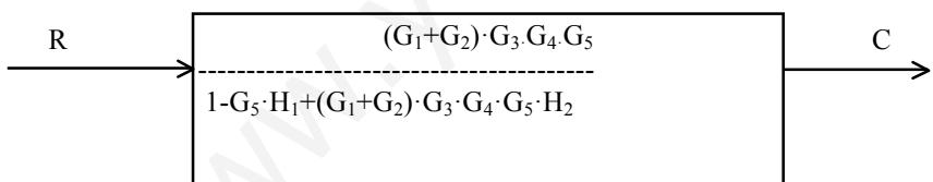
7.- Simplifica el siguiente diagrama de bloques de la figura, representando el diagrama simplificado de la función de transferencia total del sistema
