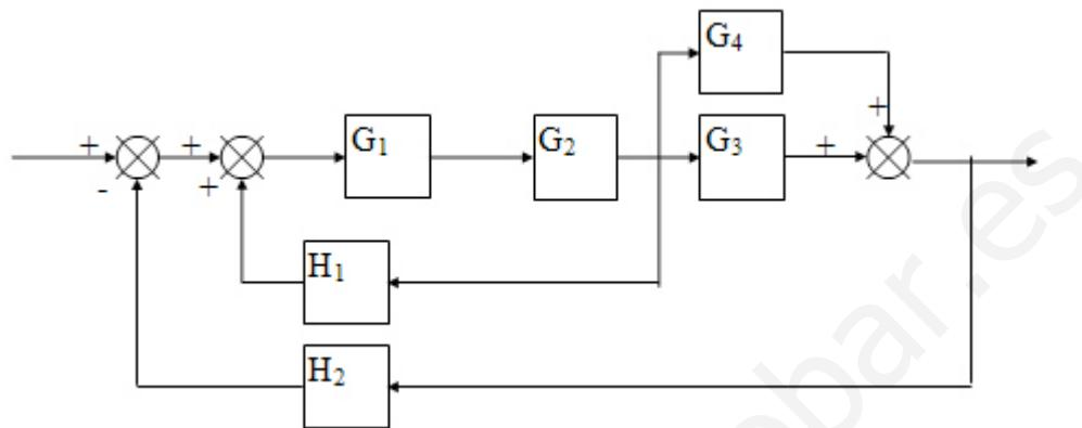
8.- Simplifica el siguiente diagrama de bloque de la figura, representando el diagrama simplificado de la función de transferencia total del sistema.
