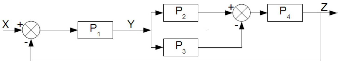
16.- **NUEVO 2011/12** Simplifica el siguiente sistema de control hasta conseguir la función de transferencia del sistema.
