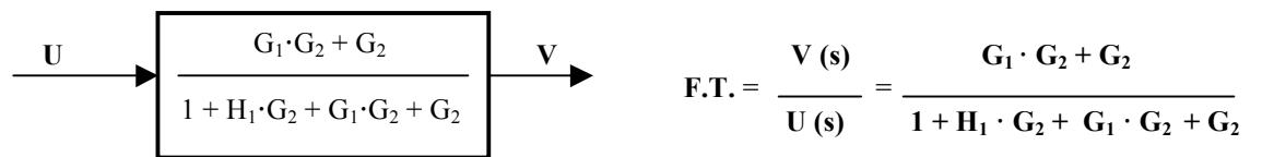
2.- Simplificar el siguiente sistema de control hasta conseguir la función de transferencia.
