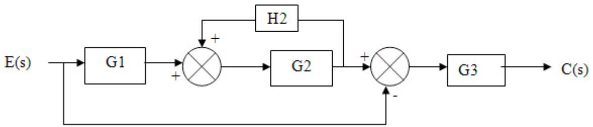
11.- Calcular y simplificar la función de transferencia del siguiente circuito.
