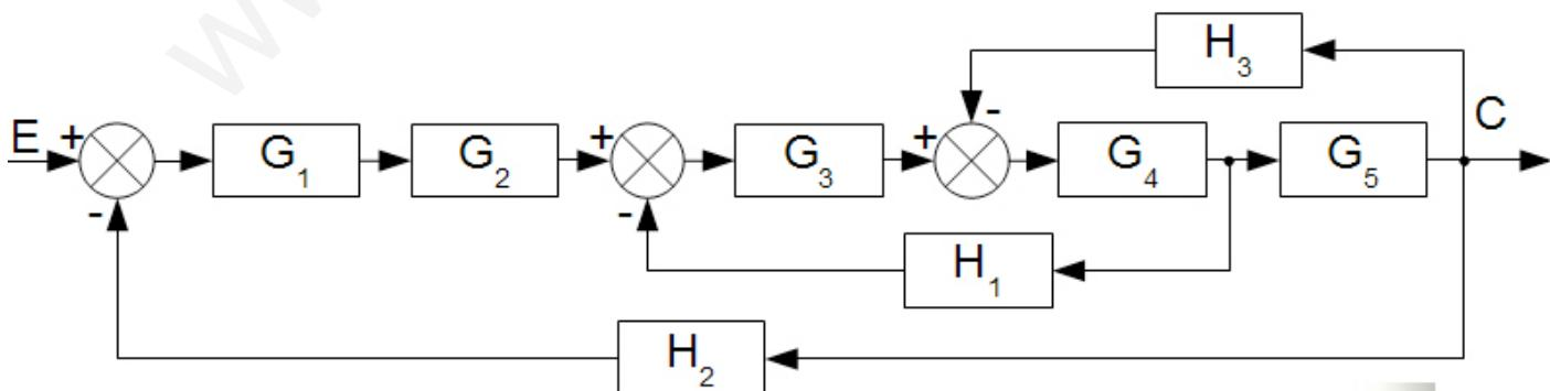
1.- Halla la función de transferencia del sistema representado mediante el siguiente diagrama de bloques.
