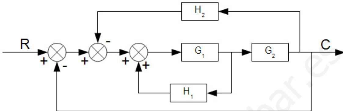
17.- **NUEVO 2012/13** Determinar la función de transferencia total del sistema caracterizado por el diagrama de bloques.
