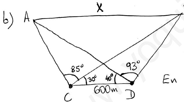
$$\text{En } \triangle BCD \quad \begin{cases} C = 30^\circ \\ D = 93^\circ + 40^\circ = 133^\circ \\ B = 180^\circ - (133^\circ + 30^\circ) = 17^\circ \end{cases}$$
