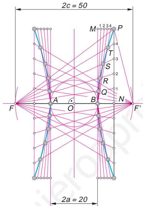
4º **Construcción de la hipérbola por envolventes** (Tercer procedimiento).
