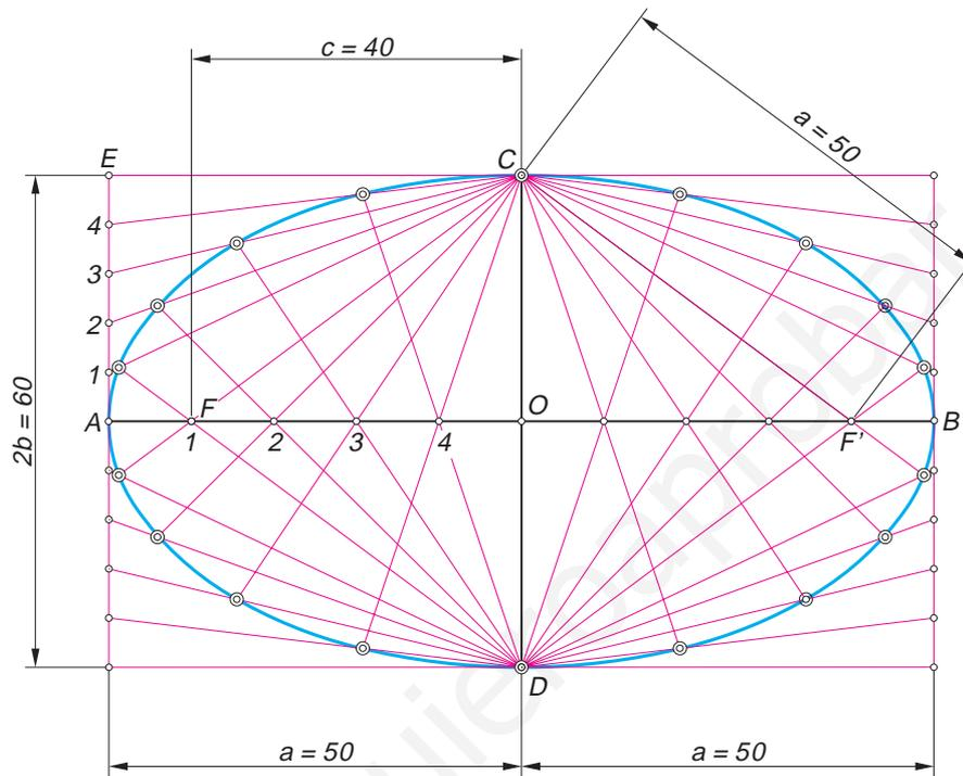
3º **Trazado de la elipse por puntos mediante la circunferencia principal y la de diámetro  $2b$ .**
