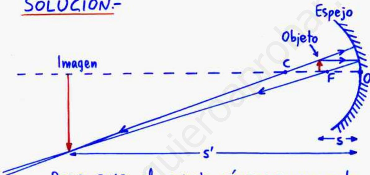
Para que el espejo cóncavo proyecte una imagen **real** -se recoge en una pantalla-, **mayor e invertida** el objeto ha de situarse **entre el centro de curvatura y el foco** del espejo, como muestra la construcción geométrica indicada arriba.
