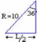
Aplicando la definición de seno de  $36^\circ$  se calcula la longitud del lado de triángulo (L/2) y de está, la del lado del pentágono regular.
