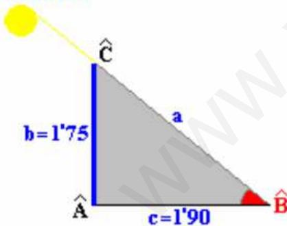
Se pide calcular las razones trigonométricas del ángulo B, para lo cual hace falta la longitud de la hipotenusa, que se calcula mediante el teorema de Pitágoras.
