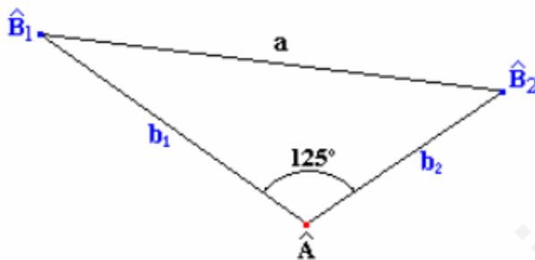
Triángulo oblicuángulo del que se conocen dos lados en función del tiempo y el ángulo que forman, y se pide la longitud del lado que falta. La solución se obtiene mediante el teorema del coseno.
