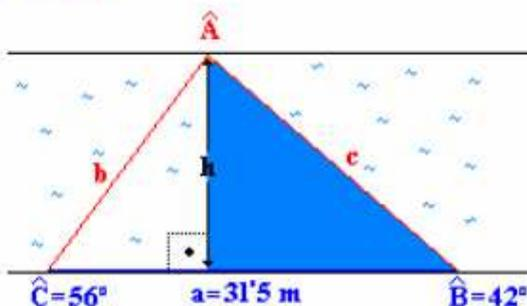
La anchura del río ( $h$ ) se puede obtener aplicando la definición del  $\sin \hat{B}$  al triángulo rectángulo resaltado en la figura.
