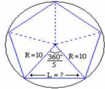
Cada triángulo isósceles a su vez se puede dividir en dos triángulos rectángulos de los que se conocería un ángulo agudo y la hipotenusa.
