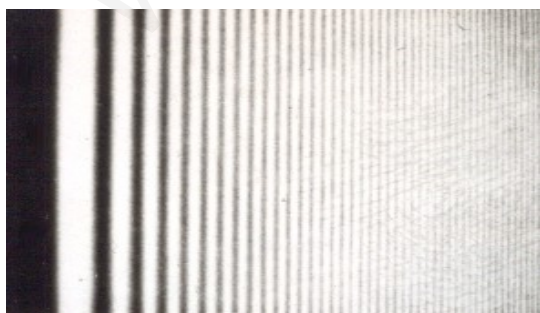
Difracción por un borde rectilíneo
