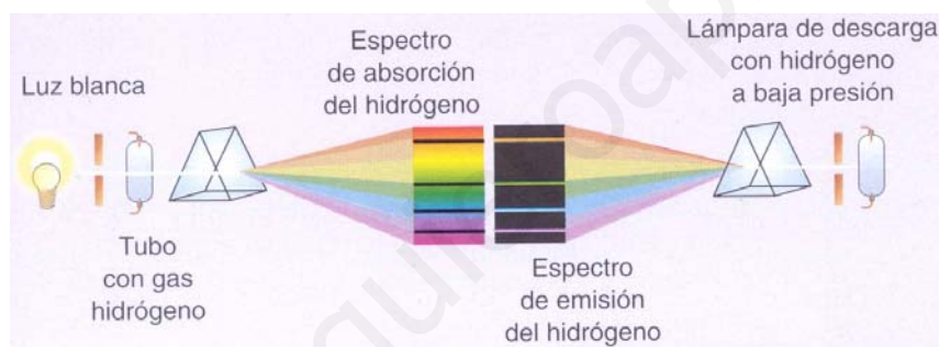
ESPECTRO DE EMISIÓN (REGIÓN VISIBLE) DEL ÁTOMO DE HIDRÓGENO
