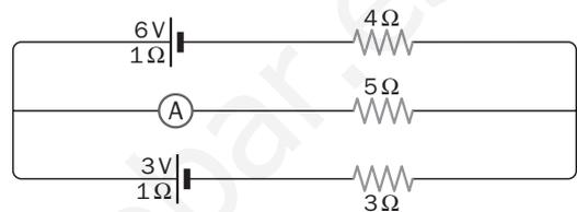
9.55 Calcula la potencia disipada por efecto Joule en la resistencia de 4 Ω del circuito de la figura.
