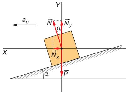
Tomando el eje  $X$  horizontal con el sentido positivo hacia el centro de la curva, tenemos, para los ejes  $X$  e  $Y$ :
