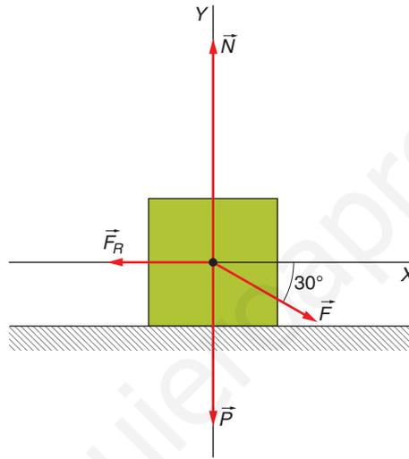
Tomando el semieje X positivo en el sentido del movimiento y recordando que el bloque se desplaza con velocidad constante, tenemos, para cada eje:
