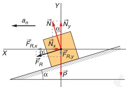
Tomando el eje  $X$  horizontal con el sentido positivo hacia el centro de la curva tenemos, en cada eje:
