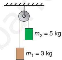
Puesto que la masa del cuerpo 2 es mayor que la del 1, suponemos que el 2 desciende y que, evidentemente, el 1 sube. El módulo de la aceleración es igual para ambos cuerpos, pues la cuerda es inextensible, y el módulo de la tensión de la cuerda es igual en todos sus puntos, aunque la dirección varíe, por ser despreciables las masas de la cuerda y de la polea.
