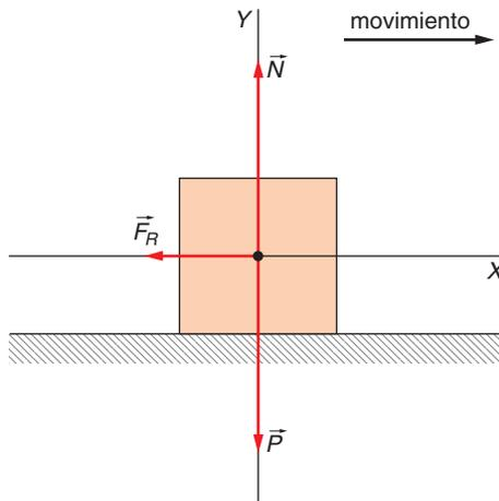
Tomando el eje  $X$  en el sentido del movimiento, tenemos, para los ejes  $X$  e  $Y$ :
