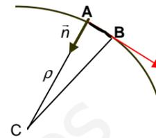
Fig.1.9. El radio de curvatura  $\rho$  es el radio de la circunferencia, tal que situado su centro en un punto C, llamado centro de curvatura, se podría trazar un pequeño elemento de arco AB de la trayectoria.
