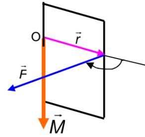
Fig.1.22. El momento de la fuerza respecto de O, es un vector  $\vec{M}$  perpendicular al plano formado por los dos vectores, con sentido el de avance de un tornillo que al girar pueda llevar al primero, en este caso  $\vec{r}$  (cuya dirección se ha prolongado) sobre el segundo  $\vec{F}$  con el giro más corto.
