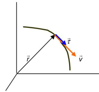
Fig.1.6. En la figura se representan el vector de posición  $\vec{r}$  y el vector velocidad instantánea  $\vec{v}$ , que es en cada punto tangente a la trayectoria. Además, se encuentra el vector unitario tangente  $\vec{e}$  que es de módulo la unidad, de dirección tangente en cada punto a la trayectoria y del mismo sentido que el vector velocidad, de modo que  $\vec{v} = v \vec{e}$ .
