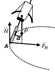
Fig.1.25. Cuando el ciclista toma la curva la  $\vec{F}_R$  al actuar hacia el centro de curvatura de la misma, hace las veces de la fuerza centrípeta. Los momentos respecto de  $G$ , de la reacción  $\vec{N}$  y de la fuerza de rozamiento  $\vec{F}_R$  se equilibran para una cierta inclinación  $\alpha$  del ciclista, de modo que puede permanecer con un laqueo, sin caerse.
