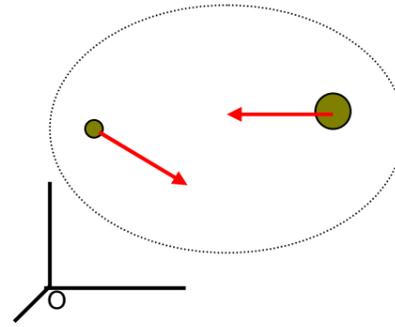
Fig.1.13. En un sistema aislado las partículas no reciben ninguna acción del medio exterior por lo que el momento lineal total del sistema  $\vec{p} = \vec{p}_1 + \vec{p}_2 = cte$ ; permanecerá constante. Los momentos lineales están medidos desde un sistema inercial O.
