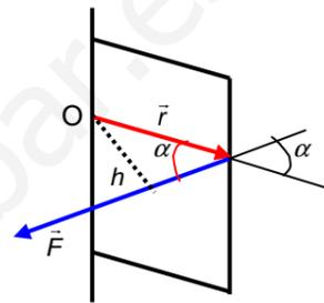
Fig.1.23. La perpendicular trazada desde O hasta la línea de acción de la fuerza es  $h = r \cdot \text{sen } \alpha$ . Se llama el brazo.
