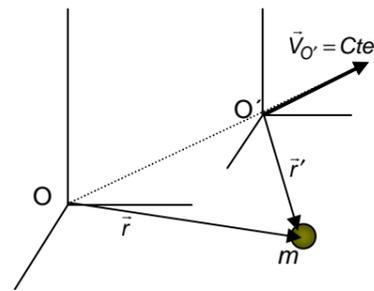
Fig.1.11. Si desde los sistemas O y O' encontramos que la partícula libre  $m$ , se halla en reposo o en movimiento rectilíneo y uniforme, entonces estos sistemas de referencia se llaman inerciales. En la práctica, consideraremos como sistemas inerciales aquellos que están en reposo o en movimiento rectilíneo y uniforme.
