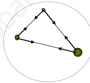
Fig.1.12. Cada una de las partículas del sistema ejerce fuerzas sobre todas las demás y a su vez recibe fuerzas de todas las otras partículas del sistema. Sobre  $m_1$  actúa las fuerzas  $\vec{f}_{12}$  y  $\vec{f}_{13}$  que le ejercen respectivamente  $m_2$  y  $m_3$ . Lo mismo sucede con las demás.
