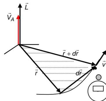
Fig.1.28. La velocidad areolar  $\vec{V}_A$  es un vector de la misma dirección y sentido que el momento angular  $\vec{L}$ . El área rayada es la que cubre el radio vector  $\vec{r}$  en un tiempo  $dt$ , y el cociente entre esta área y el tiempo empleado en recorrerla representa la velocidad areolar.
