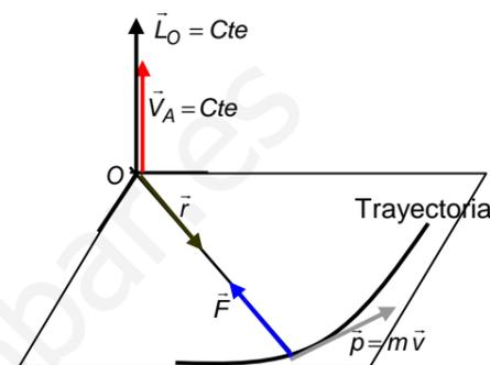
Fig.1.29. Cuando la fuerza apunta continuamente hacia el mismo punto  $O$ , se llama central y entonces el momento angular  $\vec{L}_O$  y la velocidad areolar  $\vec{V}_A$ , permanecen constantes, resultando que la trayectoria de la partícula es plana.
