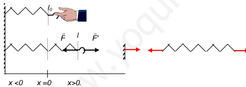
Fig.1.21. Parejas de acción-reacción en un muelle estirado
