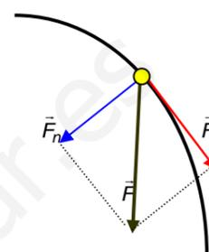
Fig.1.15 La fuerza  $\vec{F}$  aplicada a la partícula proporciona dos componentes, una tangente a la trayectoria  $\vec{F}_t$  y otra normal a la misma  $\vec{F}_n$ .
