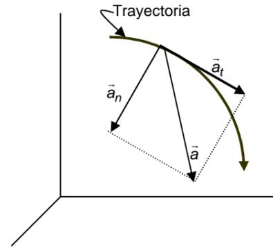
Fig.1.8. La aceleración  $\vec{a}$  es un vector dirigido hacia la concavidad de la trayectoria y tiene dos componentes intrínsecas, la aceleración tangencial  $\vec{a}_t$  y la aceleración normal  $\vec{a}_n$ .
