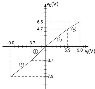
Para expresar  $v_o$  en función del tiempo se calculan los instantes en los que  $v_i$  va alcanzando los valores de las cotas: -9, -3.7, 0, 5.88, y 9 V. Esto se hace teniendo en cuenta la definición de  $v_i=9\text{sen}(1000t)$  V, expresando el tiempo en ms queda  $v_i=9 \text{ sen}(t)$  V. Se restringirá la búsqueda a un periodo de  $v_i$ :  $[0, 2\pi]$  ms. Operando queda:
