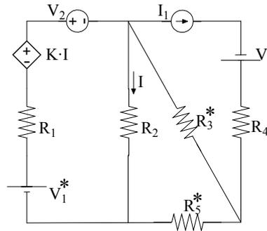
a) Resolvamos el circuito mediante el método de análisis por mallas.
